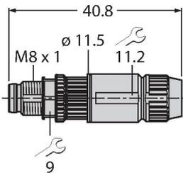
Konfektionierbarer Stecker, M8 x 1, gerade, 3-polig, Schneidklemmanschluss, Leitungsdurchlass 2.5 bis 5.1 mm, Adernquerschnitt/ Klemmvermögen 0.14 bis 0.34 mm<sup>2</sup>, Kunststoffgehäuse, Metallüberwurfmutter
