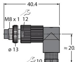
Konfektionierbarer Stecker, M8 x 1, gewinkelt, 3-polig, Eindringtechnik, Leitungsdurchlass 4.0 bis 5.0 mm, Adernquerschnitt/ Klemmvermögen 0.14 bis 0.34 mm<sup>2</sup>, Kunststoffgehäuse, Metallüberwurfmutter
