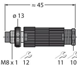
Konfektionierbarer Stecker, M8 x 1, gerade, 3-polig, Eindringtechnik, Leitungsdurchlass 4.0 bis 5.0 mm, Adernquerschnitt/ Klemmvermögen 0.14 bis 0.34 mm<sup>2</sup>, Kunststoffgehäuse, Metallüberwurfmutter
