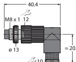
Konfektionierbarer Stecker, M8 x 1, gewinkelt, 4-polig, Eindringtechnik, Leitungsdurchlass 4.0 bis 5.0 mm, Adernquerschnitt/ Klemmvermögen 0.14 bis 0.34 mm<sup>2</sup>, Kunststoffgehäuse, Metallüberwurfmutter
