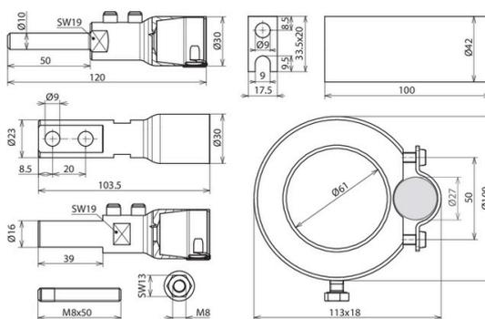
Anschlussset für HVI power Leitung zur Verlegung an HVI power Stützrohren GFK / Al bestehend aus Anschlüsselemente, Gewindestifte, Anschlusssteil, Schrumpfschlauch, Kabelbinder und Befestigungsring mit einem geschlitzten Leitungshalter (Ø27 mm).
