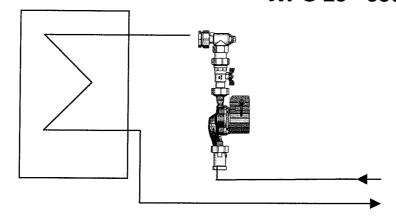
**KPV 25**Einbindung des Kompaktverteilers für Heizbetrieb und Warmwasserbereitung
