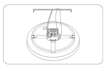
4. Führen Sie das Sicherheitsseil durch das Sicherheitsbandloch der Lampe und verbinden Sie das AC-Kabel über die Schutzspule mit dem Lampenanschluss.
