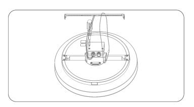
5. Verriegeln Sie die wasserdichte Anschlussabdeckung.
