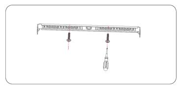
1. Schrauben Sie die Halterung an die Decke.
