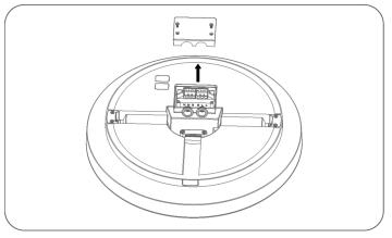
3. Entfernen Sie die wasserdichte Abdeckung mit einem Schraubendreher.
