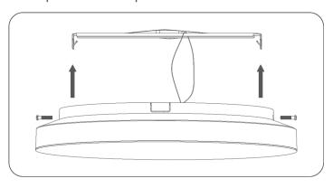
6. Schieben Sie die Lampe wie oben gezeigt in Pfeilrichtung nach oben, sodass die Spangen an beiden Enden der Lampe in die beiden Enden der Montagehalterung einras
