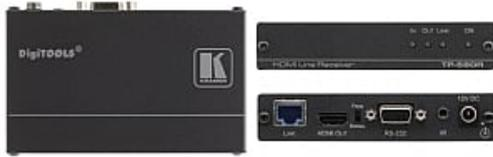
TP-580R ist ein leistungsstarker HDBaseT-Empfänger für 4K 60 Hz (4:2:0) HDMI-, RS-232- und IR-Signale über Twisted Pair. Er verlängert Videosignale bis zu 40 m über CAT-Kupferkabel mit einer Videoauflösung von bis zu 4K @60 Hz (4:2:0) 24 bpp und bietet eine noch größere Reichweite für niedrigere HD-Videoauflösungen
