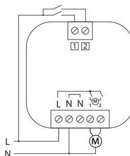
Installieren Sie JAL-01 in der Gerätedose hinter einem Taster oder in einer Abzweigdose in der Nähe des Motors.
