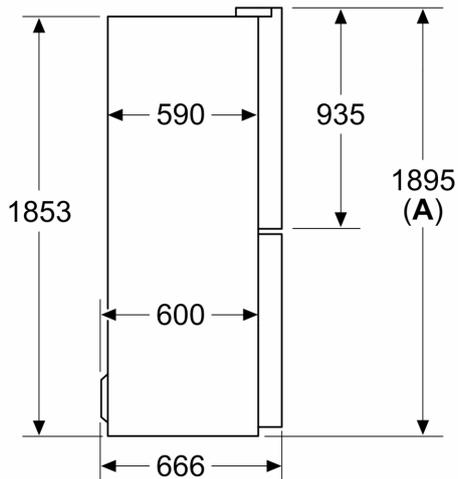
**A:** Front ist von 1895–1910 mm, bei voll ausgezogenen vorderen Nivellierfüßen, verstellbar
