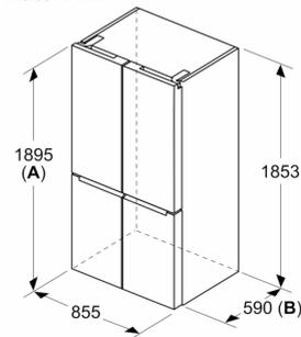
**A:** Front ist von 1895–1910 mm, bei voll ausgezogenen vorderen Nivellierfüßen, verstellbar
