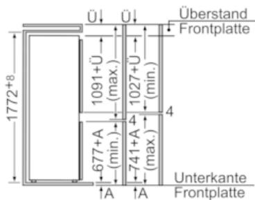
Bei größeren Maßen (1780 - 1790) muss an der Nischendecke eine Distanzleiste vorgesehen werden. Die angegebenen Möbeltürmaße gelten für eine Türfuge von 4mm. Bei Verwendung einer anderen Fugenbreite (max. 14mm) müssen die Maße angepaßt werden.
