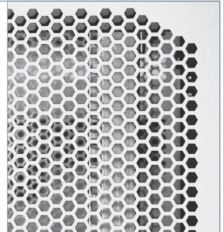
Die Tür mit 9,6 mm Sechskantlochung Perforation besitzt eine frei belüftete Fläche im Lochanteil von ca. 55%.
