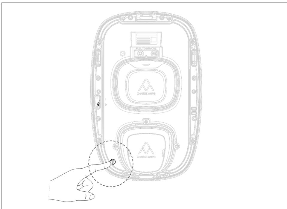
7. Der Ladevorgang wird abgebrochen und ein rotes Dauerlicht leuchtet an der Steckdose. Dieses deutet auf einen Erdfehler hin.
