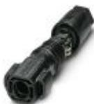
Photovoltaik-Steckverbinder, Artikelfamilie: PV-CM-S, Steckverbinder, Material Gehäuse: PPE, Farbe: schwarz, Polzahl: 1, Aderquerschnitt min.: 2,5 mm<sup>2</sup>, Aderquerschnitt max.: 6 mm<sup>2</sup>, Bemessungsstrom: 27 A, Anschlussart: Federkraft, Kontaktart: Stift
