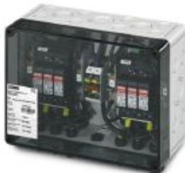
Generatoranschlusskasten für Photovoltaikanlagen bis 1000 V DC zum Anschluss von 2x 2 Strings. Mit Überspannungsschutz und SUNCLIX DC-Steckverbinder für die Eingangs- und Ausgangsseite.
