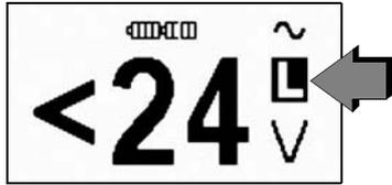
**Messung in Stromkreisen mit RCD ohne Auslösung**
