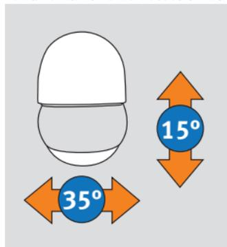
Il est possible d'orienter la zone de détection avec précision en faisant pivoter la tête du capteur à l'horizontale et à la verticale.
