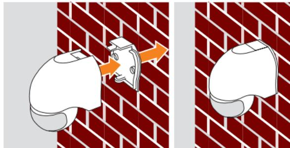
Les déplacements (par ex. vibrations) de l'appareil exercent exactement le même effet que des mouvements dans la zone de détection (par ex. d'arbres, de buissons) et ils risquent de provoquer des déclenchements par erreur.
