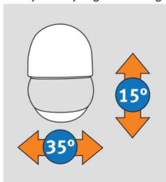
door de sensorkop horizontaal en verticaal te draaien.
