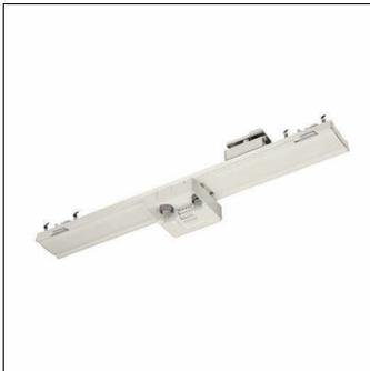
Licross® Interface Interface S, Slave, lokale Steuerung, zentrale Steuerung, dimmbar, Montageort: an der Licross® Tragschiene, aus Stahlblech, Schutzart (gesamt): IP20, Schutzklasse (gesamt): SK I (Schutzerdung), Prüfzeichen: CE, ENEC, VDE, UKCA, 1 x DALI-2, Verpackungseinheit: 1 Stück
