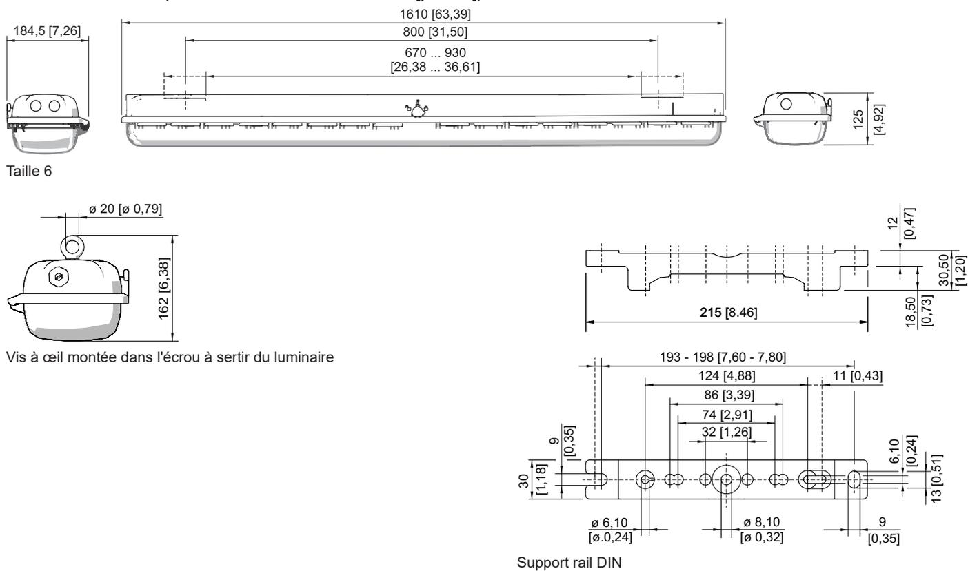
Vis à œil montée dans l'écrou à sertir du luminaire
