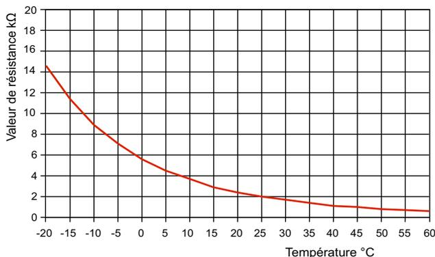
Fig. 7.2: Courbe caractéristique de la sonde NTC-2 selon DIN 44574
