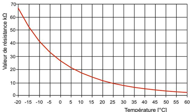
Fig. 7.1: Courbe caractéristique de la sonde NTC-10
