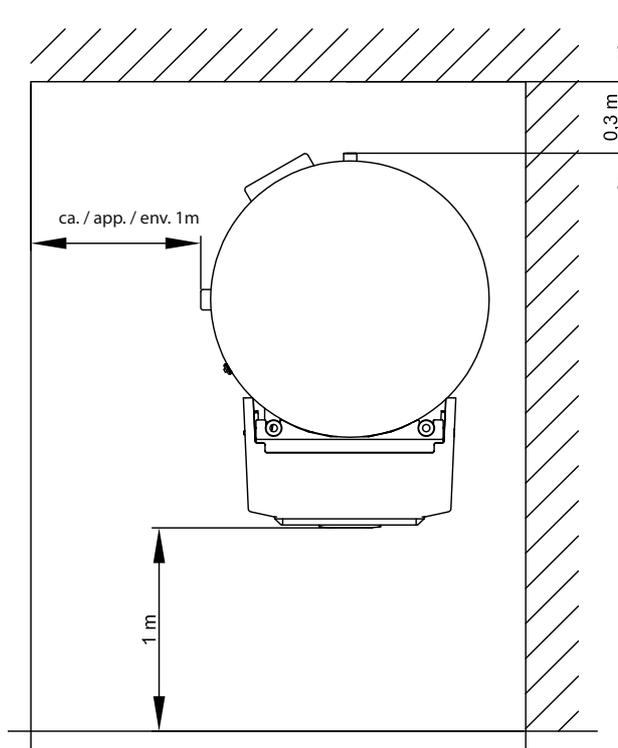
Si la tour hydraulique combinée est installée à l'étage, il faut contrôler la résistance au poids du plafond et le découplage vibratoire pour des raisons acoustiques. Une installation sur un plancher en bois ne peut être acceptée.
