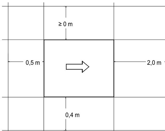
Le dimensioni indicate sono valide solo per l'installazione singola.
