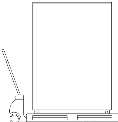
La pompa di calore e il pallet di trasporto sono tenuti insieme da 4 protezioni antiribaltamento. Le protezioni devono essere rimosse.
