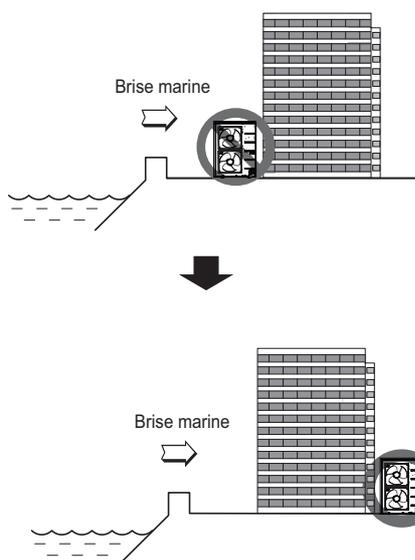
Cas 2 : si l'unité extérieure est montée dans le sens du vent de mer, installer un brise-vent pour bloquer le vent.
