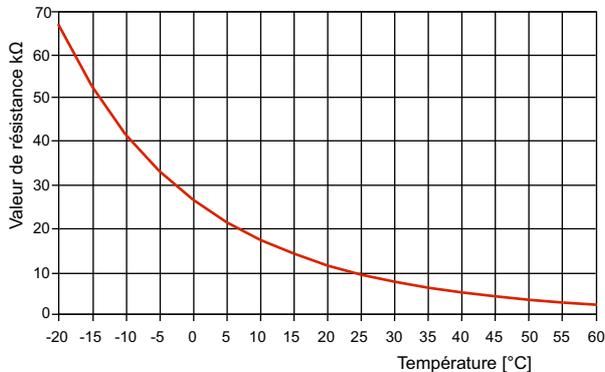
Fig. 9.1: Courbe caractéristique de la sonde NTC-10
