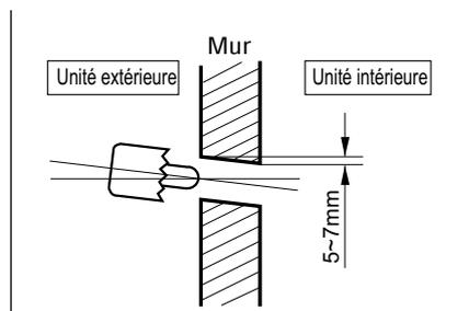
Pour une évacuation sûre des condensats, l'écoulement des condensats doit être posé de manière à ce qu'il n'y ait pas de risque de gel. La limite de gel peut varier d'une région climatique à l'autre. Respecter les consignes en vigueur dans les pays concernés.
