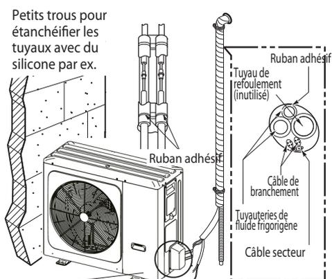
Un siphon empêche la pénétration d'eau dans le circuit électrique.
