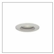
Lunis 40 IP65, Downlight, aus PMMA, Lichtaustritt: direkt strahlend, LED Bemessungslichtstrom: 350lm, Lichtfarbe: 830, Vorschaltgerät: EVG, Netzanschluss: 220..240V, AC, 50/60Hz, Gehäuse, rund, aus Aluminium, lackiert, verkehrsweiß (RAL 9016), Durchmesser: 83mm, Einbautiefe: 43mm, Schutzart (gesamt): IP20, Schutzart (raumseitig): IP65, Schutzklasse (gesamt): SK II (Schutzisoliert), Prüfzeichen: CE, zul. Umgebungstemperatur für Innenräume: -20..+40°C, Verpackungseinheit: 1 Stück
