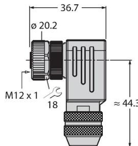
Konfektionierbare Kupplung, M12 x 1, gewinkelt, 8-polig, Schraubklemmanschluss, Leitungsdurchlass 6.0 bis 8.0 mm, Adernquerschnitt/Klemmvermögen 0.14 bis 0.50 mm<sup>2</sup>, Metallgehäuse, Metallüberwurfmutter, schirmbar
