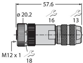
Konfektionierbare Kupplung, M12 x 1, gerade, 8-polig, Schraubklemmanschluss, Leitungsdurchlass 6.0 bis 8.0 mm, Adernquerschnitt/Klemmvermögen 0.14 bis 0.50 mm<sup>2</sup>, Metallgehäuse, Metallüberwurfmutter, schirmbar
