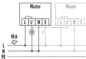
Standardbetrieb mit optionaler Ansteuerung durch Schließaster und Parallelschaltung von max. 8 Geräten
