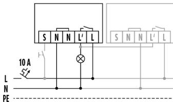
Standardbetrieb mit optionaler Ansteuerung durch Schlietaster und Parallelschaltung von max. 10 Gerten
