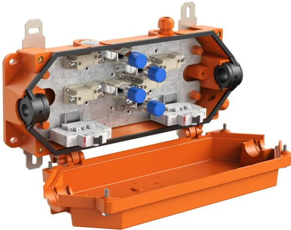
Abzweigkasten, mit Schutzart IP66/IP67,  $U_i=400\text{ V AC}$ , M25, (5 seitlich), außenliegende Befestigungsstellen, mit elektrischem Funktionserhalt E30 - E90 nach DIN 4102 Teil 12. Für Installationen im industriellen Umfeld und Tunnelbereich, Druck-Sog-Dicht nach Gotthard-Richtlinie. Halogenfreies Gehäuse aus Spezialduroplast, Klemmen aus hochtemperaturbeständiger Spezialkeramik. Außenbefestigungslaschen und Deckelschrauben aus Edelstahl 1.4571
