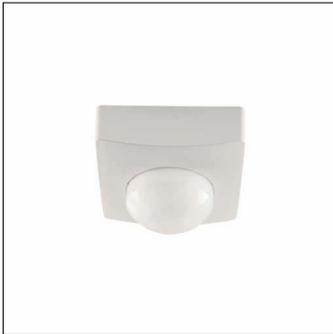
Siteco Connect Sensor-HeadSensor-Head PC5-M, Master, lokale Steuerung, schaltbar, dimmbar, Montageart: Einsteckmontage, Montageort: am Interface, aus Kunststoff, Schutzart (gesamt): IP54, Prüfzeichen: CE, VDE, 1 x PIR-Bewegungssensor, 1 x Lichtsensor, 1 x IR-Empfänger, Verpackungseinheit: 1 Stück
