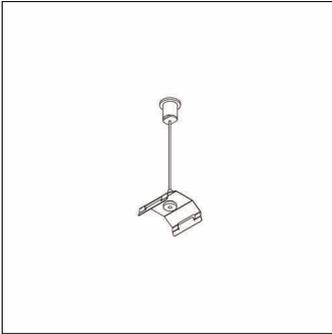
Silica® 21, Seilabhangung, Deckenhulse, aus Stahl, Seil, aus Stahl, verzinkt,
