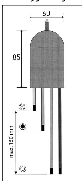
L'elettrodo speciale a 4 poli viene fornito con una lunghezza elettrodi di circa 180 mm.
