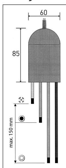
Die 4-polige Spezialelektrode wird mit einer Elektrodenlänge von ca. 180 mm geliefert.
