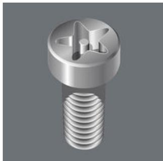
Ein 5-Flanken TORX PLUS® Profil mit Bohrung. Diese Abtriebsgeometrie wurde um eine Flanke verringert und mit Bohrung versehen, um Sicherheitsverschraubungen vor unerwünschtem Lösen zu schützen. Diese Schrauben können nicht mit gängigen, im Handel erhältlichen Werkzeugen betätigt werden. Achtung: Sicherheitsprofil – Verkauf ausschließlich an autorisierte Kunden. Berechtigung muss schriftlich nachgewiesen werden.
