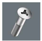
Das TRI-WING® Schraubsystem findet sich vorwiegend in der Luftfahrt- und Haushaltstechnik (hier z. B. an stromführenden Teilen). Die asymmetrische Anordnung der drei Profilflanken verhindert den Einsatz von anderen als den Original-Werkzeugen. Die hochpräzise Profilausführung garantiert den sicheren Sitz der Werkzeugs in der Schraube. Die Klingen werden aus Bit-Material gefertigt. Das Wera Know-how in bezug auf die Härtetechnik sorgt für eine lange Lebenszeit des Werkzeugs.
