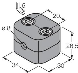
Befestigungsschelle für Glatt- und Gewinderohrsensoren; Werkstoff: Polypropylen
