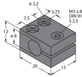
Befestigungsschelle für Gewinderohrsensoren; Werkstoff Montageblock: Aluminium, eloxiert
