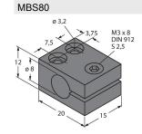
Befestigungsschelle für Gewinderohrsensoren; Werkstoff Montageblock: Aluminium, eloxiert
