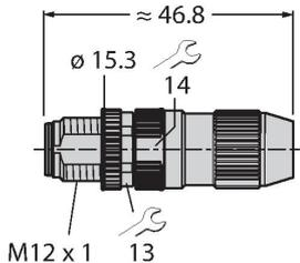
Konfektionierbarer Stecker, M12 x 1, gerade, 4-polig, Schneidklemmanschluss, Leitungsdurchlass 4.0 bis 5.1 mm, Adernquerschnitt/ Klemmvermögen 0.14 bis 0.34 mm<sup>2</sup>, Kunststoffgehäuse, Metallüberwurfmutter
