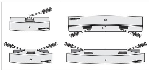
Nach dem Abnehmen des Oberteils die Anschlussklemme am ORS 142 W vorsichtig mit einem kleinen Schraubendreher anheben und abziehen. Befestigungsschrauben entfernen und den ORS 142 W durch leichtes abkanten von der Kabelleiste lösen.
