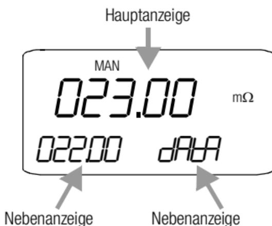
Während die Hauptanzeige unmittelbar nach dem Einschalten des Milliohmmeters erscheint, müssen die beiden Nebenanzeigen durch Betätigen der Taste DATA/CLEAR aktiviert werden.
