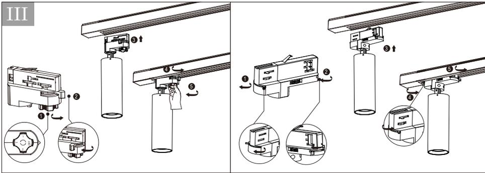
Schritt 1 + 2: Phase wählen (3 Phasen); Kompatible 3-Phasenschienen: Global, Eutrac, Nuco, Ivela, Staff, Norlux, Powergear, Stucchi, Erco.
