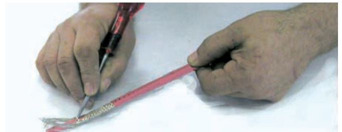
2. Trennen Sie das Schutzgeflecht bzw. den Aluschirm auf.
