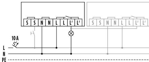
Standardbetrieb mit optionaler Ansteuerung durch Schließaster und Parallelschaltung von max. 10 Geräten
