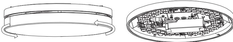
Abdeckung kann mittels Bajonettverschluss geöffnet werden.
