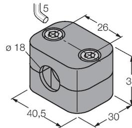
Befestigungsschelle für Glatt- und Gewinderohrsensoren; Werkstoff: Polypropylen
