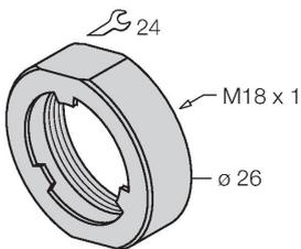
Stoßschutzmutter für M18x1 Gewinderohrgeräte; Werkstoff: Edelstahl A2 1.4305 (AISI 303)
