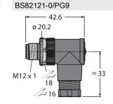
Konfektionierbarer Stecker, M12 x 1, gewinkelt, 12-polig, Lötkontakt, Leitungsdurchlass 6.0 bis 8.0 mm, Adernquerschnitt/ Klemmvermögen 0.14 bis 0.25 mm², Kunststoffgehäuse, Metallüberwurfschraube
