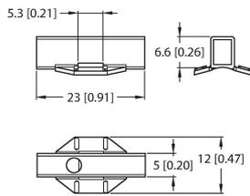
Klemmstück zur Montage von Magnetfeldsensoren auf Rundzylindern
