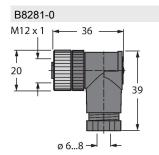
Konfektionierbare Kupplung, M12 x 1, gewinkelt, 8-polig, Schraubklemmanschluss, Leitungsdurchlass 6.0 bis 8.0 mm, Adernquerschnitt/ Klemmvermögen 0.14 bis 0.50 mm², Kunststoffgehäuse, Metallüberwurfmutter
