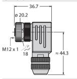
Konfektionierbare Kupplung, M12 x 1, gewinkelt, 8-polig, Schraubklemmanschluss, Leitungsdurchlass 6.0 bis 8.0 mm, Adernquerschnitt/Klemmvermögen 0.14 bis 0.50 mm², Metallgehäuse, Metallüberwurfmutter, schirmbar
