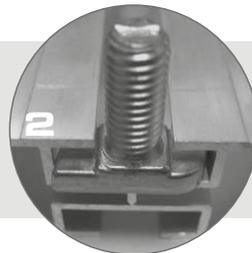
Schraube drehen: (Kerbe quer); Mutter aufsetzen und festschrauben
