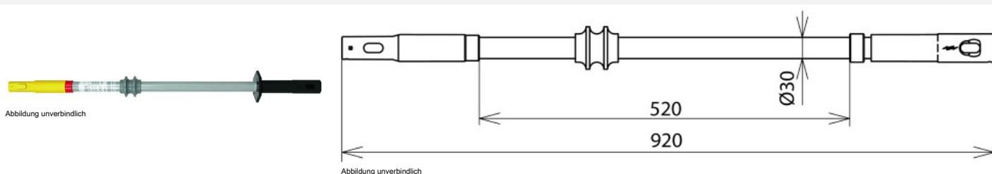
Isolierstange mit Steckkupplung für Arbeitskopf (Hammer)
