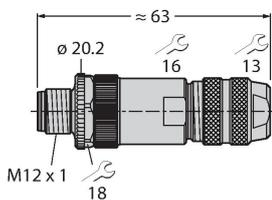
Konfektionierbarer Stecker, M12 x 1, gerade, 5-polig, Schraubklemmanschluss, Leitungsdurchlass 6.0 bis 8.0 mm, Adernquerschnitt/Klemmvermögen 0.14 bis 0.75 mm<sup>2</sup>, Metallgehäuse, Metallüberwurfmutter, schirmbar
