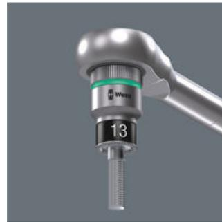
Die Klemmung der Außensechskant-Schraube im Steckschlüsseinsatz wird durch zwei federnde Kugeln und einen dauerelastischen hochfesten Schrumpfschlauch gewährleistet. Dieser wird durch einen vorderen Stahlbund wirksam gegen mechanische Verletzungen geschützt. Besonders hilfreich in schwer zugänglichen Arbeitsbereichen, wo man die zweite Hand nicht zum Festhalten der Schraube nutzen kann.
