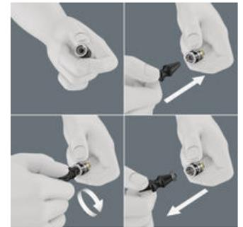
Mit diesem Werkzeug können Schraubenmutter einfach aus Steckschlüsseinsätzen mit Haltefunktion entnommen werden.
