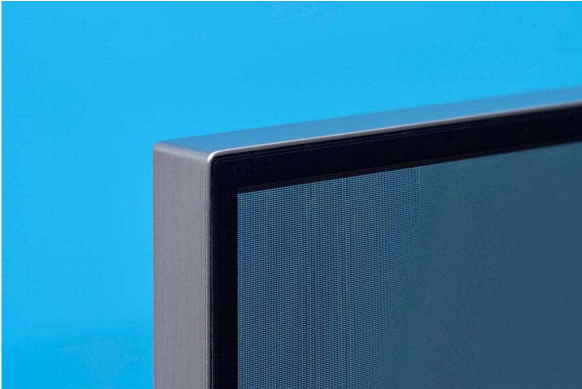
Der LG G4 ist genauso dünn wie sein Vorgänger, der Alu-Rahmen gerade mal 1,4 cm breit. Dazu kommt noch das flache Gehäuse auf der Rückseite.
