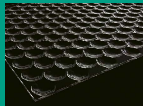
Das mikroskopische Linsenraster soll an die Facettenaugen von Insekten erinnern, vor jedem Pixel liegen Tausende Linsen.
