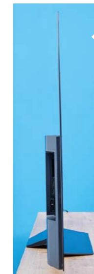
Ultraflaches Display oben, unterer Bereich mit all der Technik.
