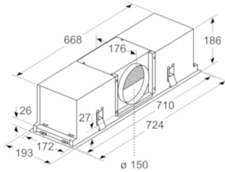
Der Stutzen kann abhängig von der Einbausituation versetzt werden.
