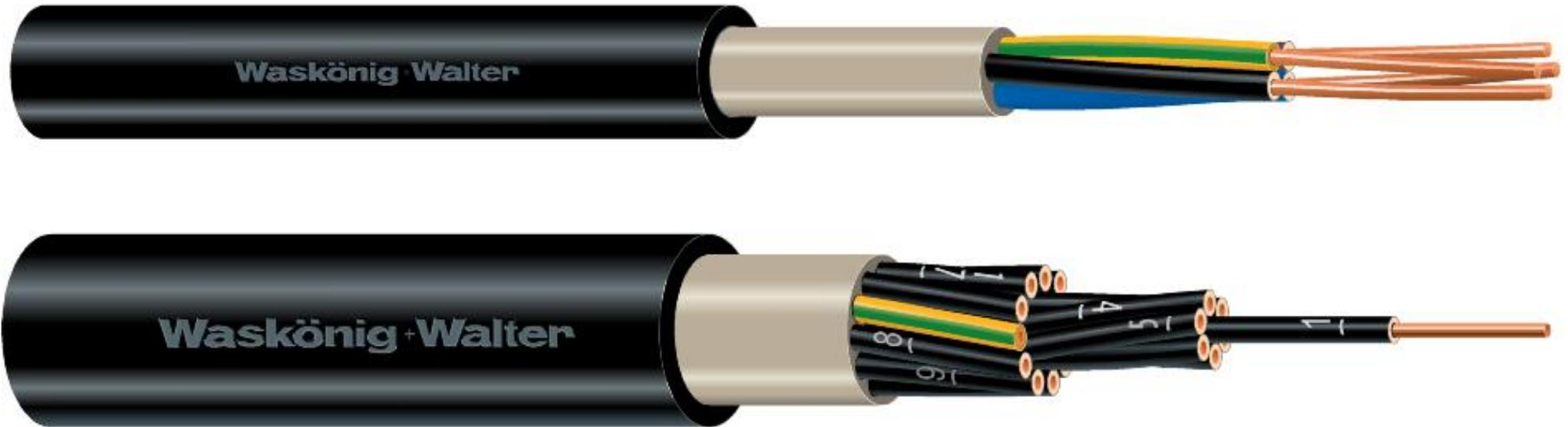
Nach VDE 0276 Teil 603 und 627. Zur festen Verlegung in Innenräumen, im Freien, in Erde, in Wasser und in Beton. Ausführungen mit SM-Leitern alternativ mit Folienbewicklung. Hinweis: Bei Verdrahtung in Leuchten siehe unter Downloads "Verlegehinweise für Leitungen bzw. Kabel".
